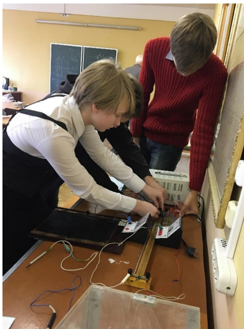
Рис. 2. Выполнение лабораторной работы «Электростатическое поле на модели с использованием электродов различной формы»
